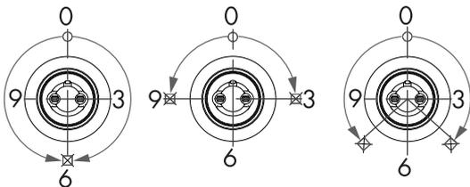
**MOVIMENTI POSSIBILI TRAMITE KIT RONDELLE FORNITE**
